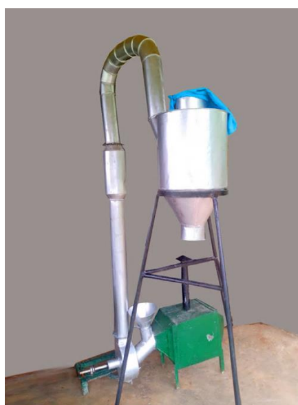
Figure 3. The complete mini multipurpose flash dryer
